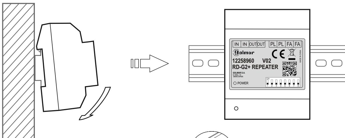
De RD-G2+ module kan met lichte druk op een DIN-rail (4 elementen) worden gemonteerd.
