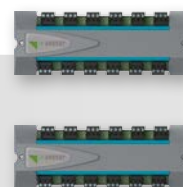
GE-125-020 GE-125-021 Uitbreidingskaart met ingangen en uitgangen 12 ingangen (020) en 12 uitgangen (021)
